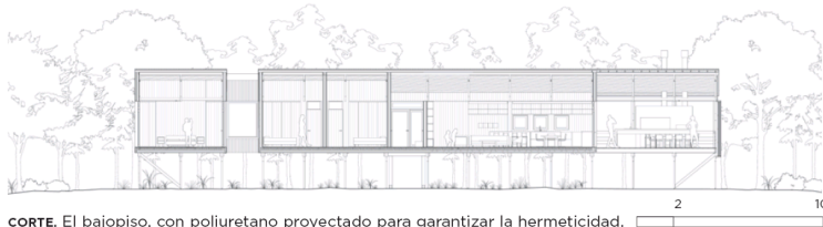
CORTE. El bajopiso, con poliuretano proyectado para garantizar la hermeticidad.
